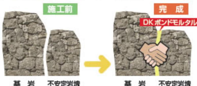
発生源となる浮石や転石の落下を抑制することを目的とし、落石発生源に対して直接実施
