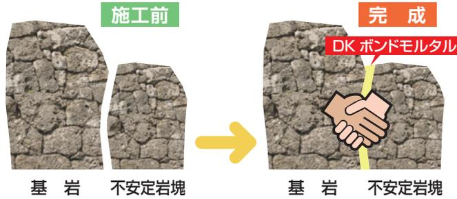
発生源となる浮石や転石の落下を抑制することを目的とし、落石発生源に対して直接実施
