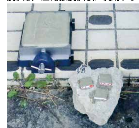
写真2： DKボンドモルタルのサンプル。 右下が引張接着試験、左上が曲げ強度試験と圧縮強度試験に使用する
