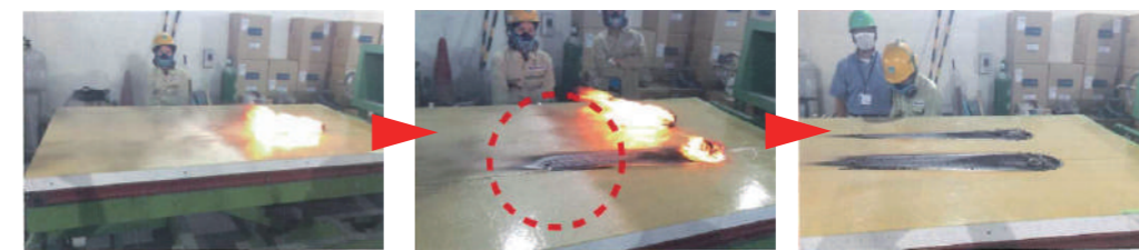
①種火から延焼開始 ②延焼中後、分離部分が自己消化 ③種火が消え完全消化
