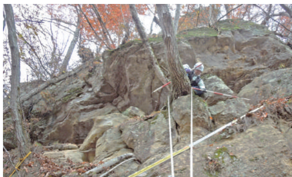
▲風化により岩盤が張り出したオーバーハング状の発生源斜面。
